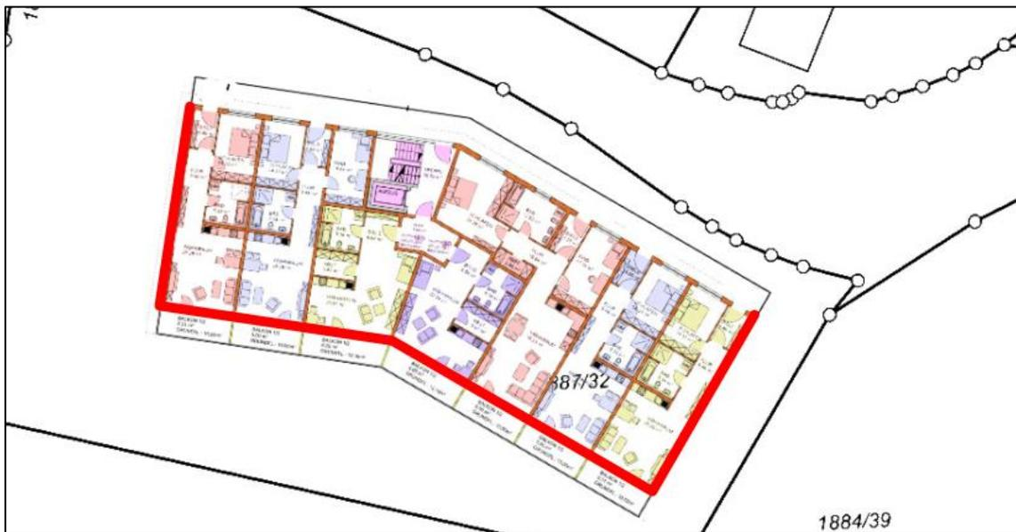
Abbildung 8: Lageplan mit Kennzeichnung der Bereiche und der Fassaden, an denen Schallschutzmaßnahmen erforderlich sind
