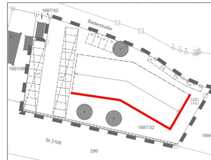
Abbildung 1: Lageplan mit Kennzeichnung der Bereiche und der Fassaden, an denen Schallschutzmaßnahmen erforderlich sind
